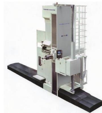
Горизонтальные фрезерно-расточные станки с подвижной колонной
