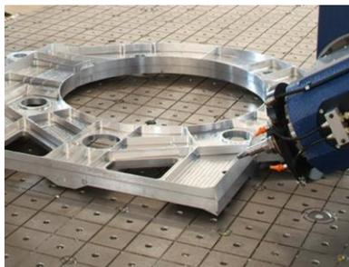
Фрезерования корпусных элементов из алюминия
